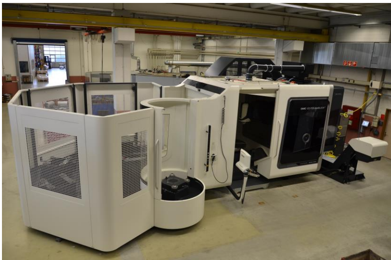
( Bild: Auf dieser Maschine können Teile bis zu 2 Tonnen in einer Aufspannung gedreht, gefräst und geschliffen werden)
